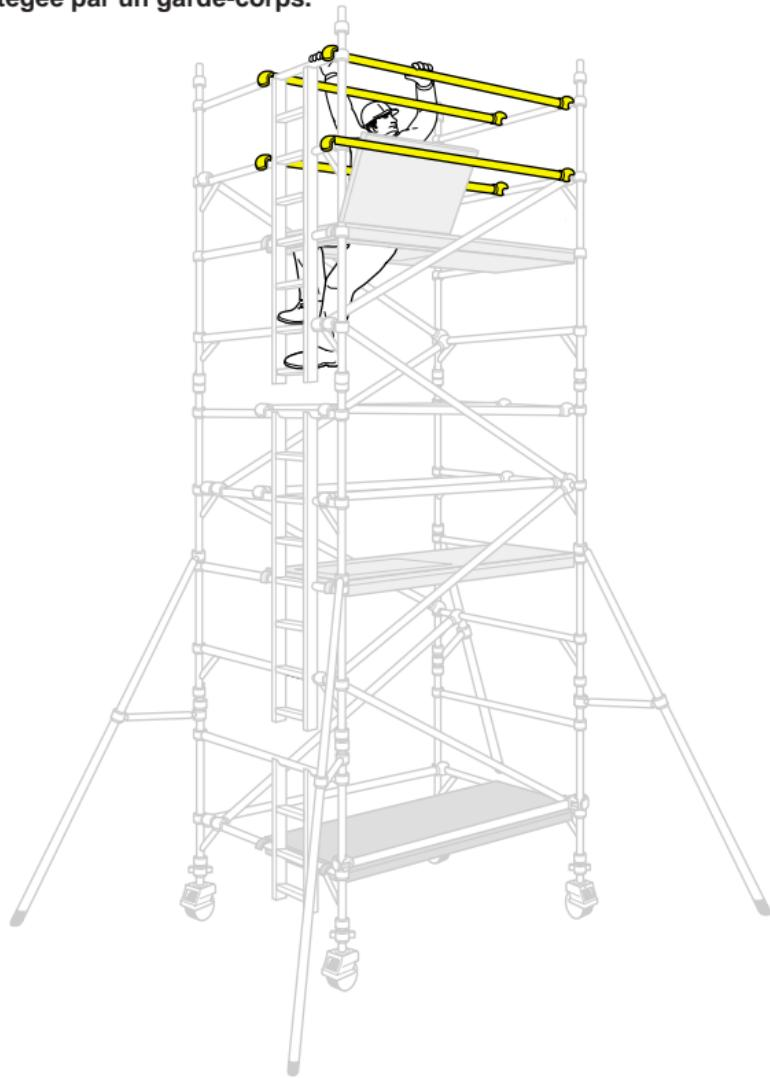
Continuer jusqu'à atteindre la hauteur requise. Repositionner le plancher fixe à la hauteur de plate-forme requise et installer un plancher en parallèle comme indiqué dans **l'étape 7**. Installer une diagonale simple au sommet de l'échafaudage comme indiqué dans **l'étape 7**. Installer les horizontales finales (garde-corps) comme indiqué dans **l'étape 7**.
