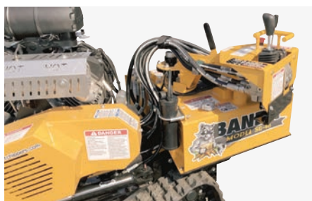
Poste déporté avec joysticks à commande proportionnelles.
