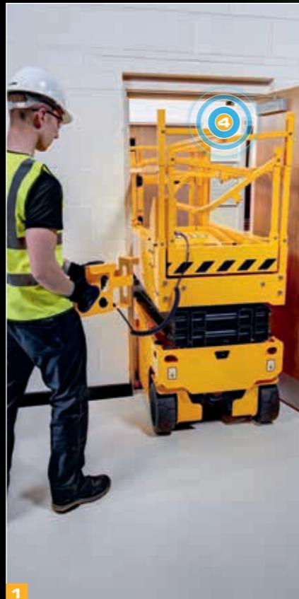
**2** Le support de commande peut être fixé sur n'importe quel côté de la machine ou peut être tenu de la main gauche ou droite pour une grande facilité d'utilisation.
